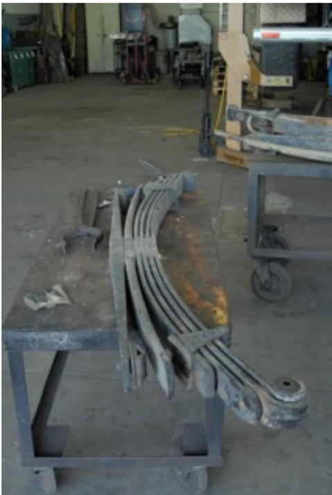
Altes Federpaket der Hinterachse
