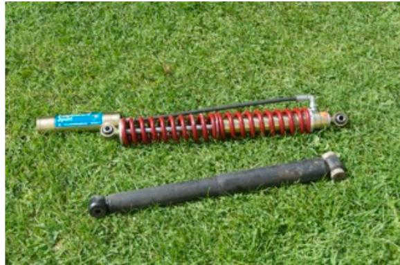
Stossdämpfer neu und alt für Hinterachse
